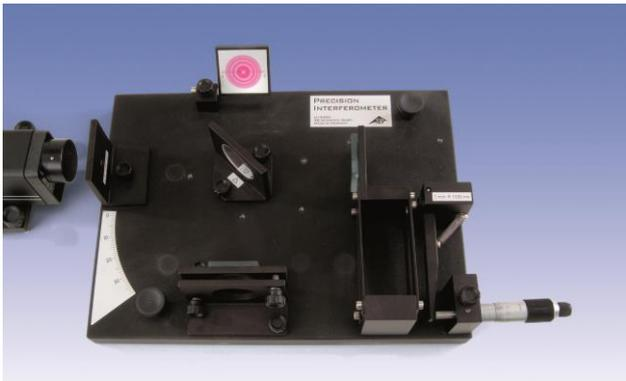
Fig. 2: Interferómetro de Michelson
