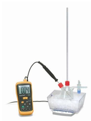
Fig. 2: Montaje experimental para la determinación de la densidad máxima del agua
