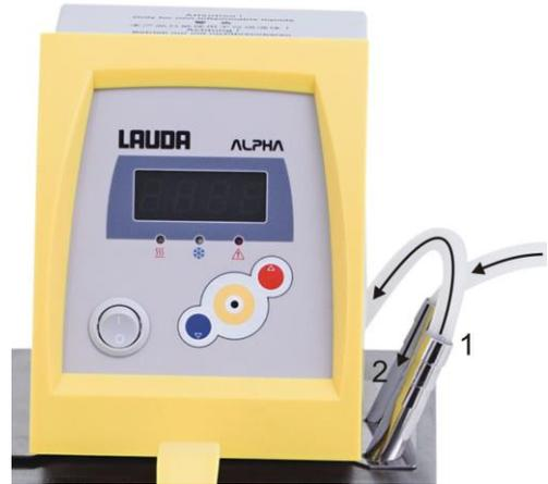
Fig. 10: Avance (1) y retorno (2) del juego de circulación de la bomba.
