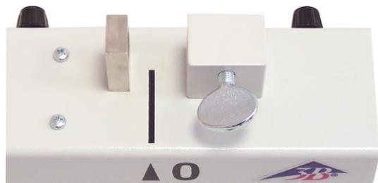
Fig. 4: Se atornilla el adaptador para el reloj comparador.
