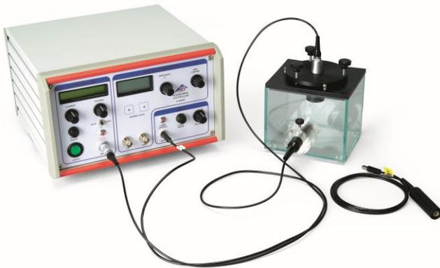
Fig. 3: Montaje de medida para la difracción de la luz en una rejilla de fase producida con ondas ultrasónicas en un líquido
