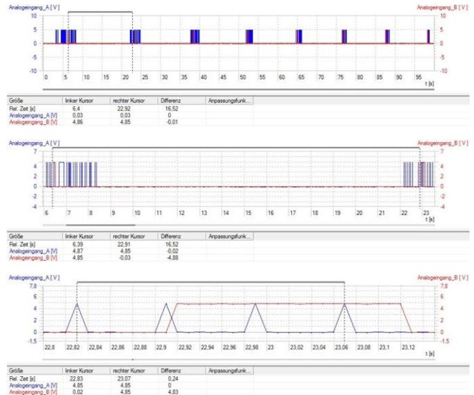
Fig. 6 Precesión del giroscopio. Curso temporal registrado (arriba) así como determinación del tiempo de precesión  $T_P$  (centro) y tiempo de rotación  $T_R$  (abajo) en el 3B NETlab™
