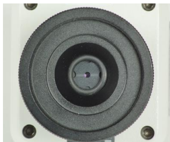
Fig. 1: Diafragma insertado en el objetivo de enfoque y fijado con la anilla en O.
