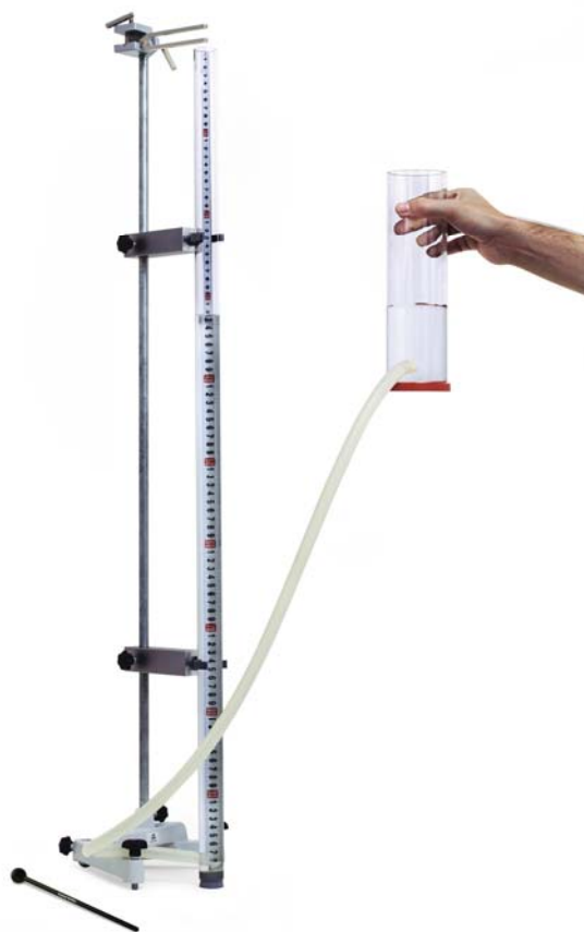
Fig. 1: Tubo de resonancia de Quincke en funcionamiento.
