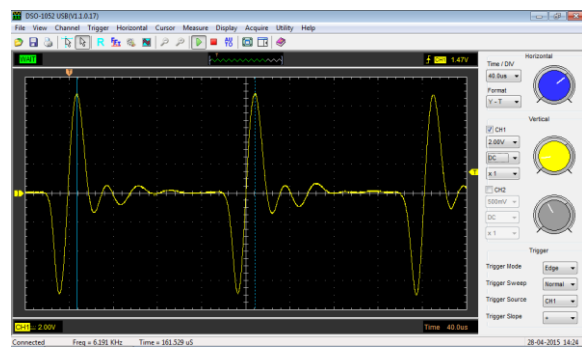
Fig. 2 Paquetes de oscilaciones en una barra de acero inoxidable de 400 mm de longitud después de una excitación en forma de impulso
