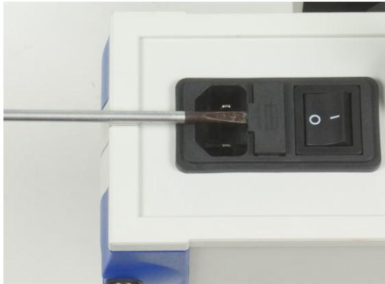
Fig. 1 Reemplazo de fusibles
