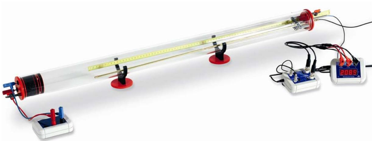
Fig. 2: Montaje experimental con el tubo de Kundt
