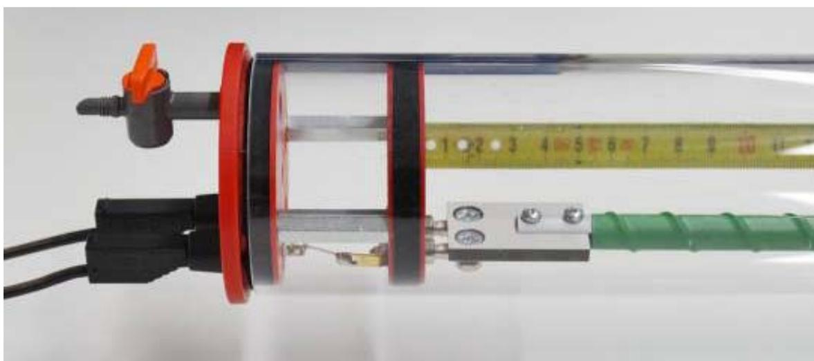
Fig. 1 Conexión enchufada de la barra calefactora K
