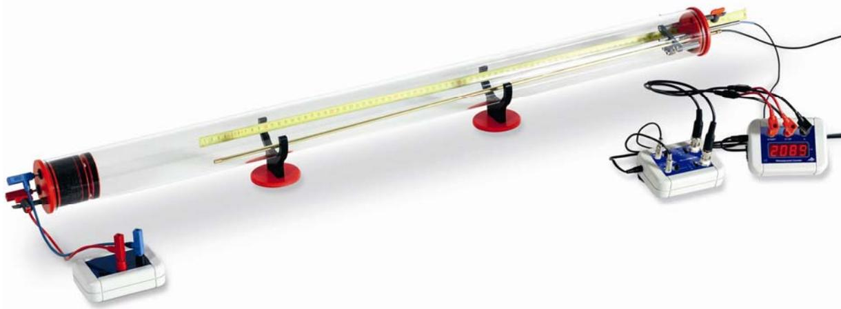
Fig. 2: Montaje experimental con el tubo de Kundt
