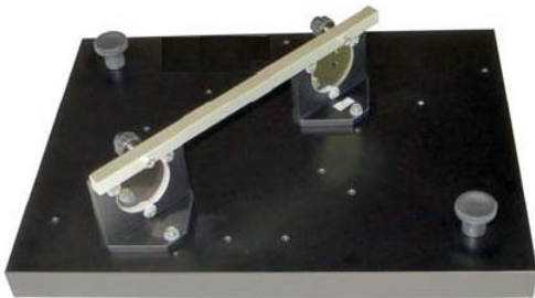
Fig. 2 Herramienta de montaje para el divisor de rayo
