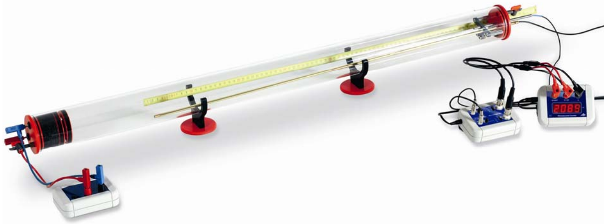
Fig. 1 Montaje experimental con el tubo de Kundt
