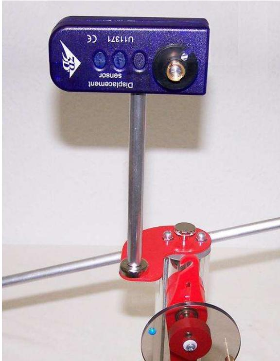
Fig. 2: Montaje del captador de camino
