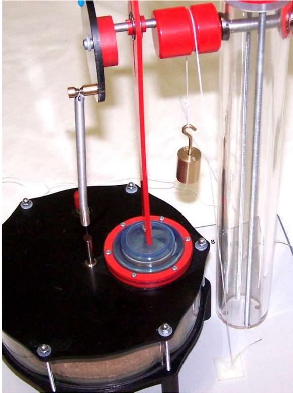
Fig. 6: Fijación del hilo con una pesa
