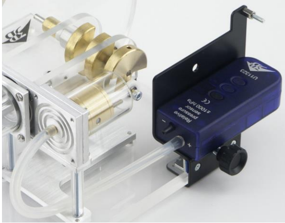
Fig. 2 Montaje del sensor de presión
