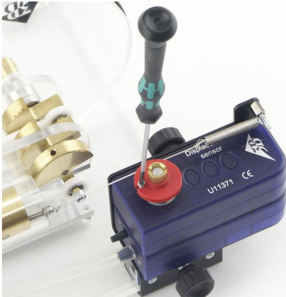
Fig. 8 Fijación del hilo
