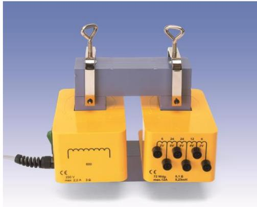
Fig.1 Transformador desarmable
