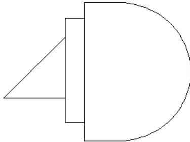
Posición de los prismas para la inversión de la visión de arriba hacia abajo (vista lateral de las gafas de inversión)
