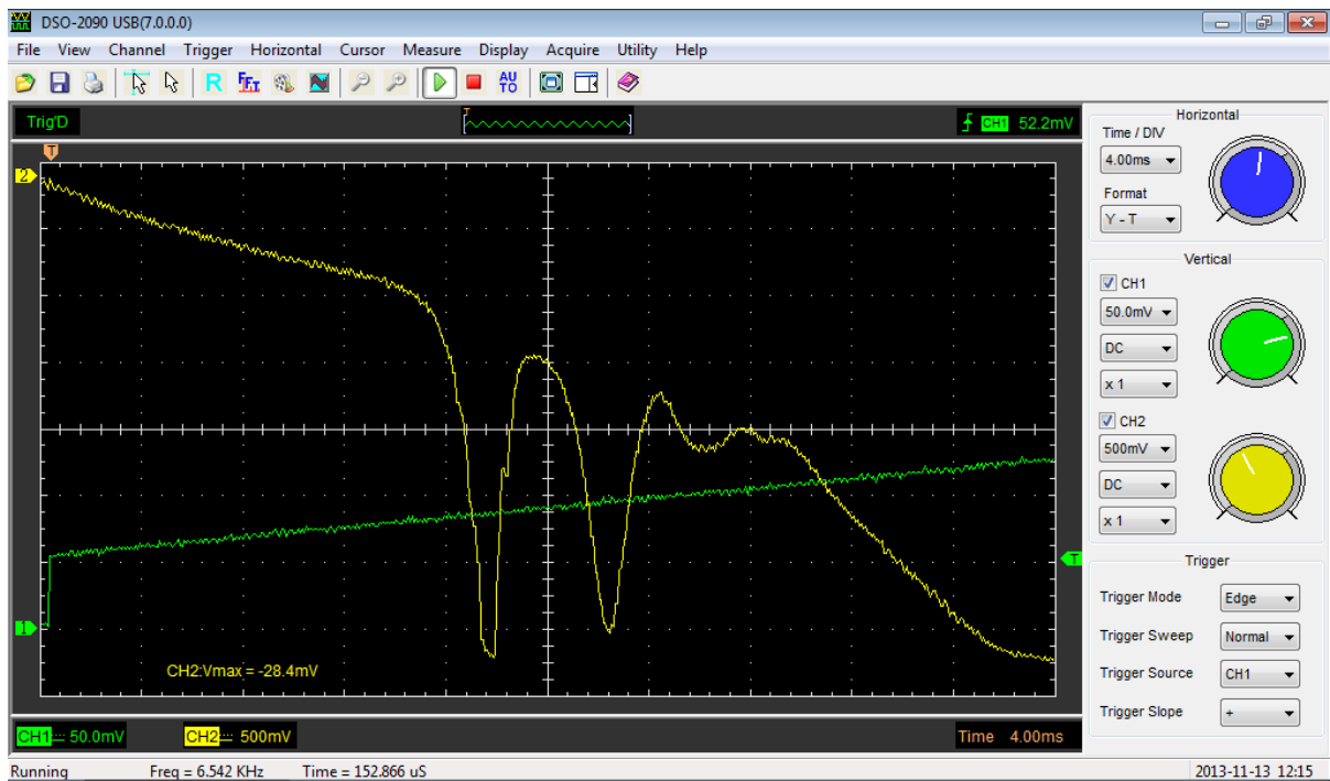
Fig. 3: Determinación de los potenciales críticos del átomo de Ne (Curva de medida registrada con el 3B NET/og™). Energías de excitación a 16,6 eV ( 2p^{53s^1} nivel), 18,4 eV ( 2p^{53p^1} nivel), 19,7 eV ( 2p^{54s^1} nivel), 20,3 eV ( 2p^{54p^1} nivel) y 20,6 eV ( 2p^{54d^1} nivel) y energía de ionización a 21,6 eV
