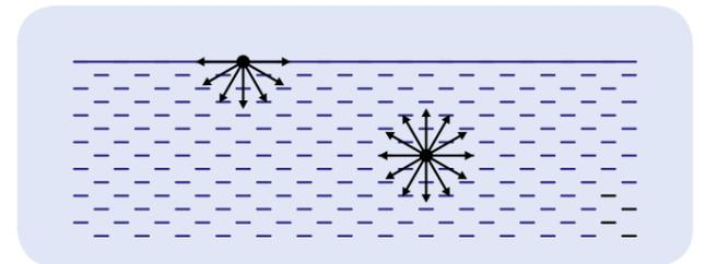
Fig. 1: Fuerzas de interacción sobre una molécula de líquido en la superficie y en el interior del mismo producidas por las moléculas vecinas
